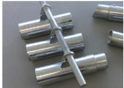
図14：水平ルーバーと下地接合部のモックアップ
