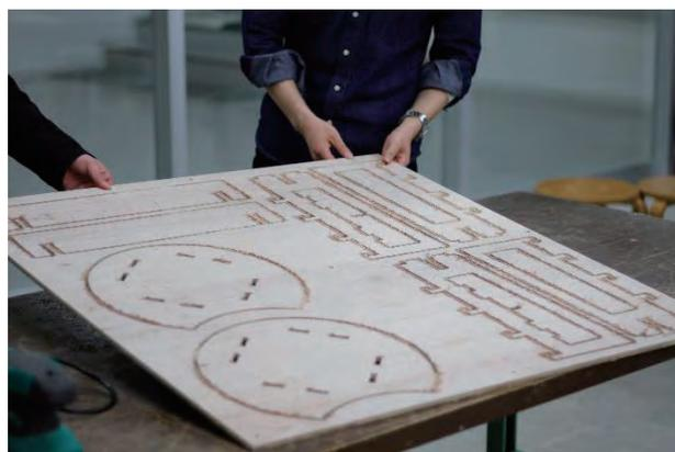
図4 CNCで切り出されたツールのパーツ
