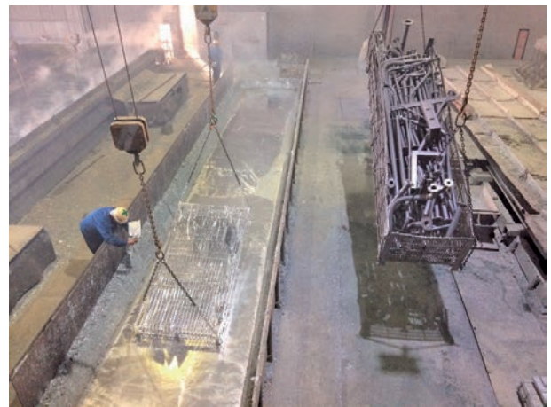
溶融亜鉛メッキ槽
