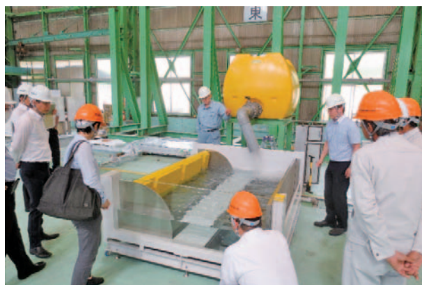
大型水槽による作動状況と止水性能確認
