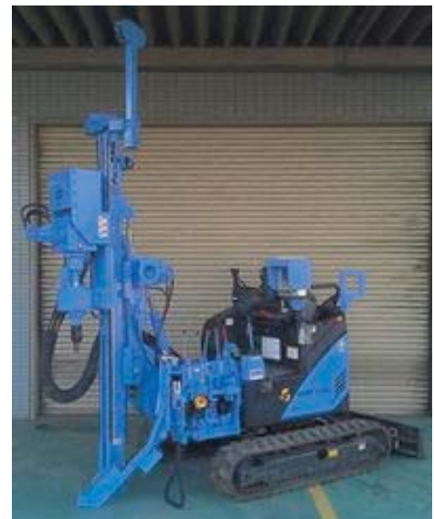
バイブロドリル式ボーリングマシン
