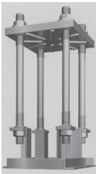
露出型弾性固定柱脚工法
