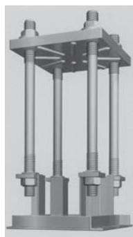
露出型弾性固定柱脚工法
